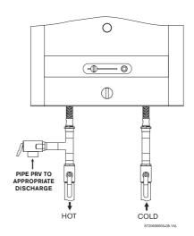
Fig. 7 - Pressure Relief Valve
