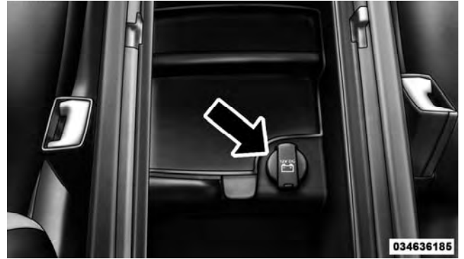
Center Console 12 Volt Power Outlet
