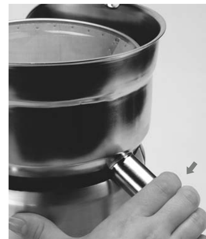
ÉTAPE 6. Pour enlever le panier-filtre en acier inoxydable, tenez la base de l'extracteur et faites tourner l'enveloppe protectrice en la tenant par le bec verseur.
