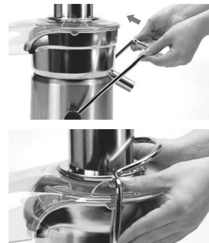
ÉTAPE 4. Relevez le bras de verrouillage de sûreté et placez-le dans les deux rainures situées de chaque côté du couvercle. Le bras de verrouillage de sûreté devrait maintenant être en position verticale et verrouillé au dessus du couvercle.
