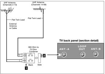
Figure 1. Connecting separate UHF and VHF antennas.
