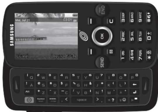
Al abrir la parte deslizante del teléfono, la pantalla gira desde el modo de visualización vertical al modo de visualización horizontal.
