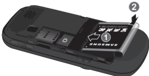
6. Vuelva a instalar la cubierta de la batería deslizando en el teléfono, hasta que se escuche un clic indicando que está segura.
