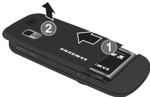
2. Levante con cuidado la cubierta de la batería, separándola de la parte inferior del teléfono (2).
