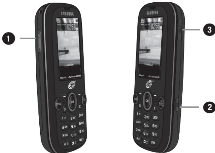
1. **Teclas de volumen:** le permiten ajustar el volumen del timbre en el modo de espera (con el teléfono abierto) o ajustar el volumen de voz del interlocutor durante una llamada. Cuando recibe una llamada, si presiona la tecla de volumen, puede silenciar el tono del timbre. Si presiona y mantiene presionada la tecla de volumen, puede rechazar la llamada.
