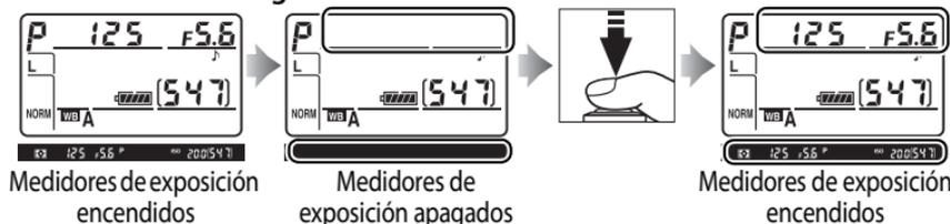
El tiempo que debe transcurrir para que los medidores de exposición se apaguen automáticamente puede ajustarse mediante la configuración personalizada c2 (**Retardo apagado med. auto.**, pág. 296).
