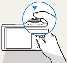
Enfoncez le **[Déclencheur]** à mi-course pour régler la mise au point. L'appareil photo règle automatiquement la mise au point et l'exposition.
