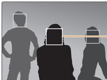
Le visage le plus proche de l'appareil photo ou du centre de la prise apparaît dans un cadre de mise au point tandis que les autres sont encadrés en gris.
