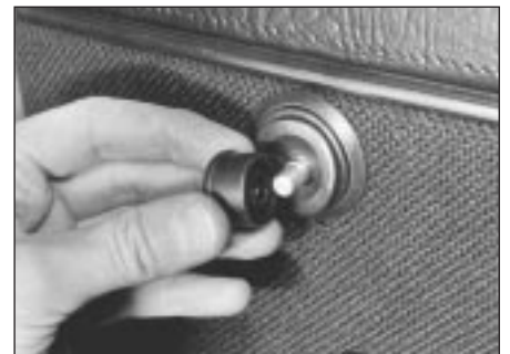
14.5 Removing door mirror adjuster knob
