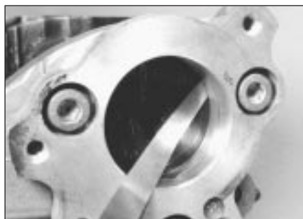
10.12 Checking camshaft endfloat
